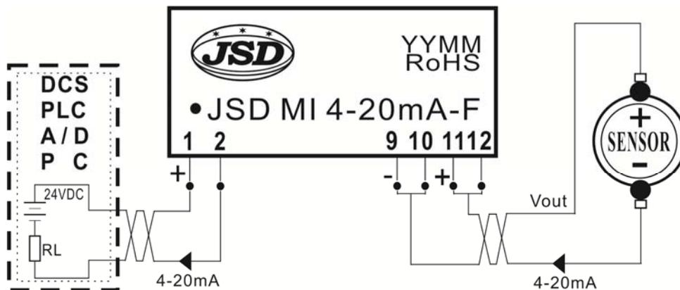
电流输入/电流输出 (无源隔离配电器)
