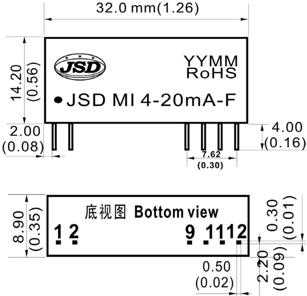
SIP 12 Pin 封装 PCB布板尺寸
