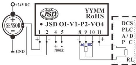
电压输入/电压输出 (V/V隔离)
