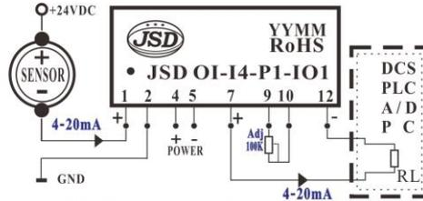
电流输入/电流输出 (I/I隔离)
