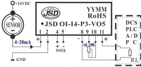
电流输入/电压输出 (I/V转换)
