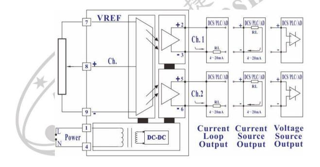
备注 3: 如果输出信号大小与位移或角度相反,则将 7 脚和 9 脚的连接线相交换; 如果是两线制传感器设备,则需要定制为恒流驱动,接线直接连接到 8 脚和 9 脚即可。
